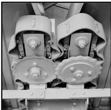
*Fig 16: detalle de los discos de corte autoafilables de alta duración.*
